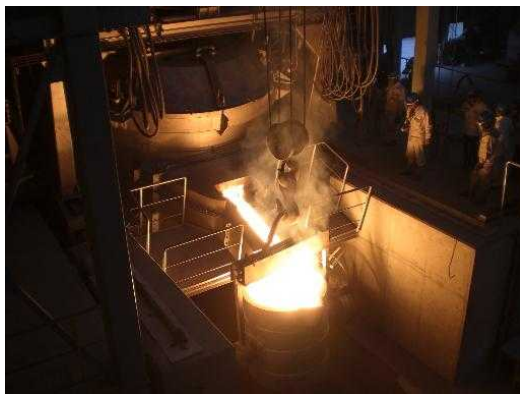
合金鉄製造電気炉からの溶解物出湯の様子
