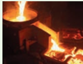
溶解した合金鉄を型枠に流し込んでいる様子
