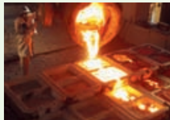
溶解した合金鉄を型枠に流し込んでいる様子
